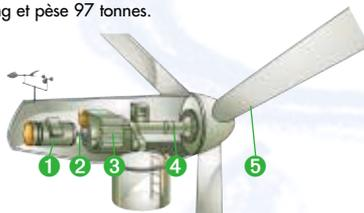
Entrainé par les pales ①, un premier arbre, dit "lent" ②, attaque un multiplicateur ③ (une sorte de boîte de vitesse). Ce dernier ajuste, à sa sortie, la vitesse d'un nouvel arbre, qualifié de "rapide" ④, aux caractéristiques de la génératrice ⑤, qui produit l'électricité.
