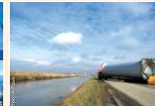
Arrivée en camion sur le Polder d'un segment de mât qui peut peser jusqu'à 44 tonnes et mesurer 26 mètres.
